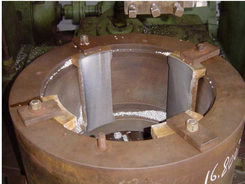
Figura 1 – Usinagem das telhas dos mancais. As telhas foram montadas para usinagem em um “mandril”.
