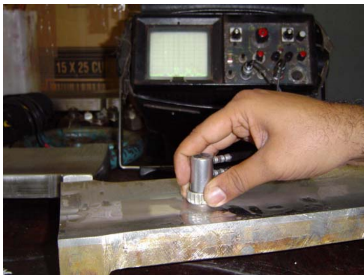
Figura 6 – Fase de ensaio de ultra-som da telha do mancal.
