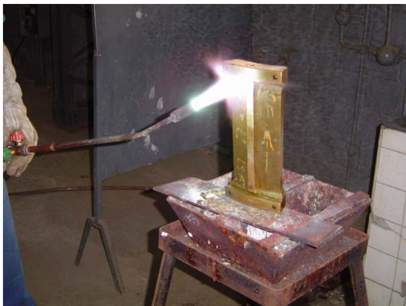
Figura 2 – Fase de aquecimento da telha do mancal.
