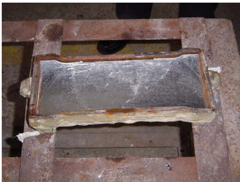
Figura 3 – Fase de estanhagem da telha do mancal.
