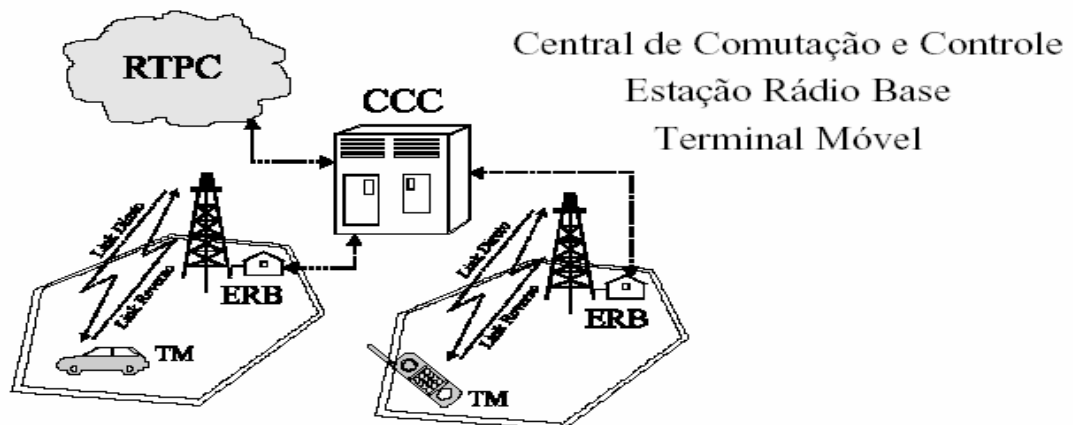
Figura 1 - Componentes de um sistema celular
