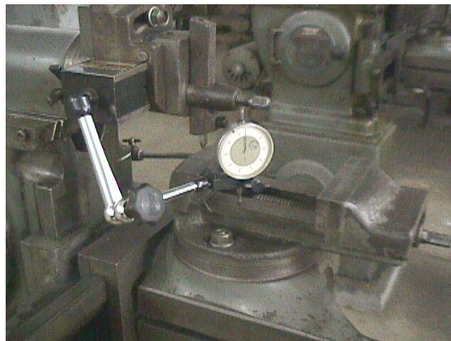
Figura 2. Montagem do procedimento de verificação de paralelismo entre o movimento do torpedo e a guia do mordente
