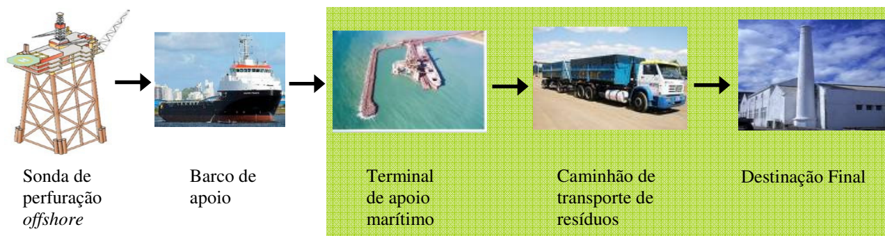
Figura 1 – Ciclo operacional da distribuição dos resíduos de sondas de perfuração offshore , Fonte: próprio autor
