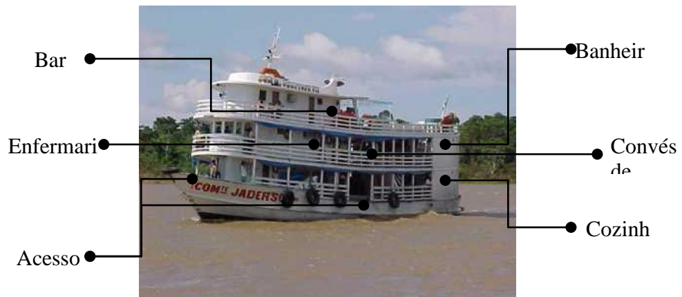
Figura 3 - Conjunto de critério a serem usados para classificação das embarcações.
