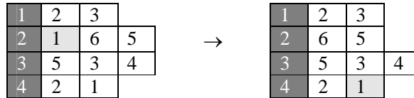
Figura 5. Exemplo de movimento REALOCAÇÃO quando o cliente já existe na rota destino.
