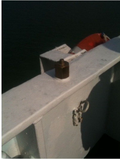
Figuras 7 e 8: Suporte metálico para instalação da antena ao guarda-corpo do passadiço
