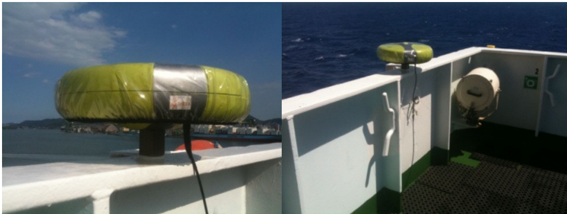
Figuras 9 e 10: – Antenas dos receptores GPS instaladas sobre o guarda-corpo do passadiço
