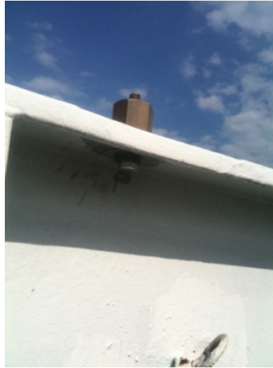
Figuras 7 e 8: Suporte metálico para instalação da antena ao guarda-corpo do passadiço
