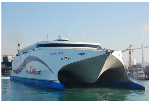
Figura 12-silhueta típica de um um barco de alta velocidade com casco do tipo catamaran
