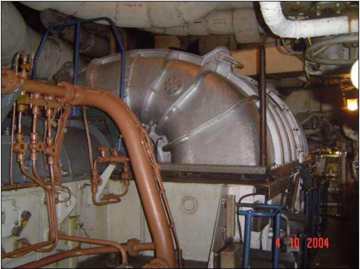
Foto Nº 1- Vista da turbina de alta pressão de bombordo e do interior da praça de máquinas, lado acoplado
