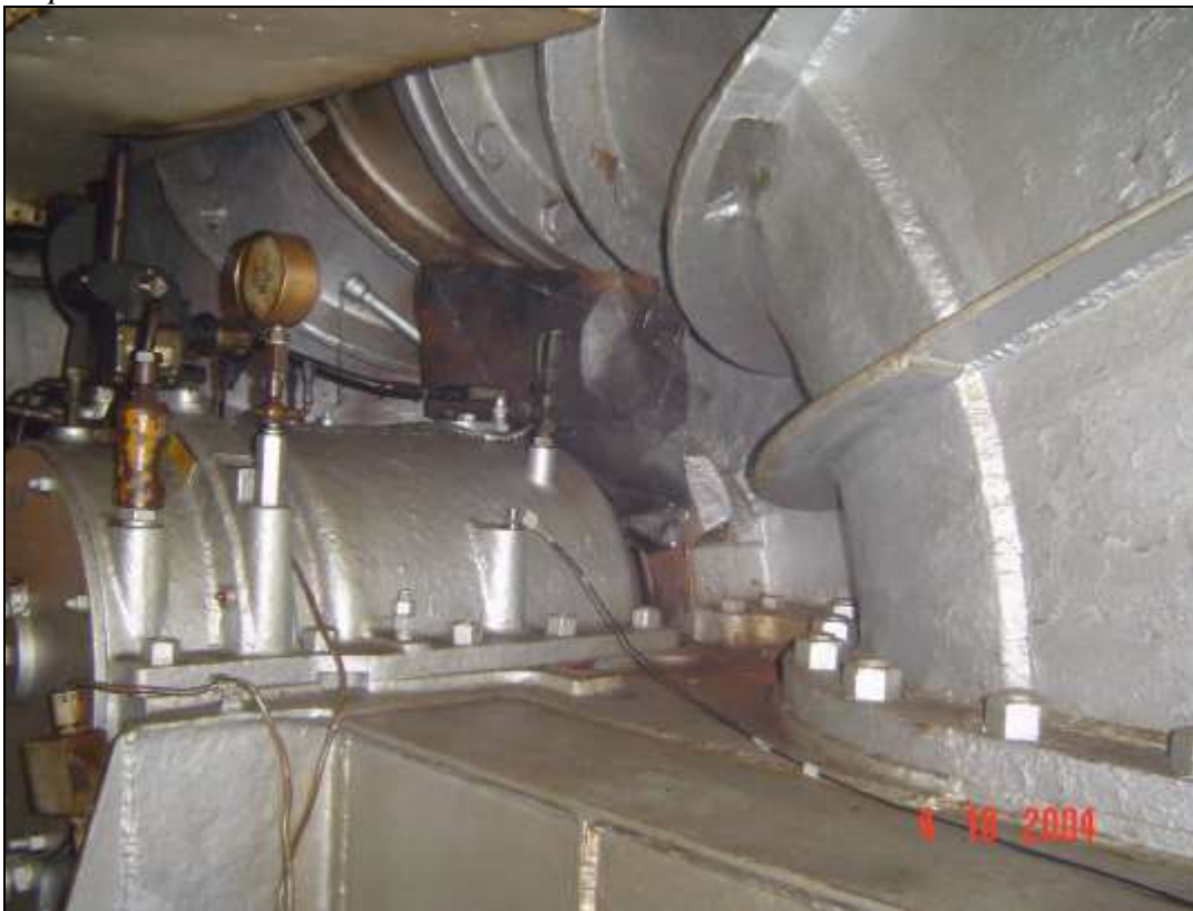
Foto Nº 1- Vista da turbina de alta pressão de bombordo e do interior da praça de máquinas, lado acoplado
