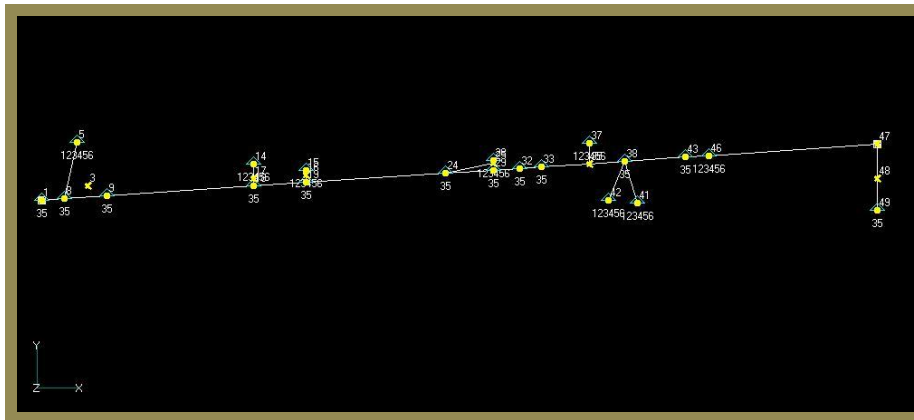
Figura 2-A modelagem da linha de eixo por elementos finitos
