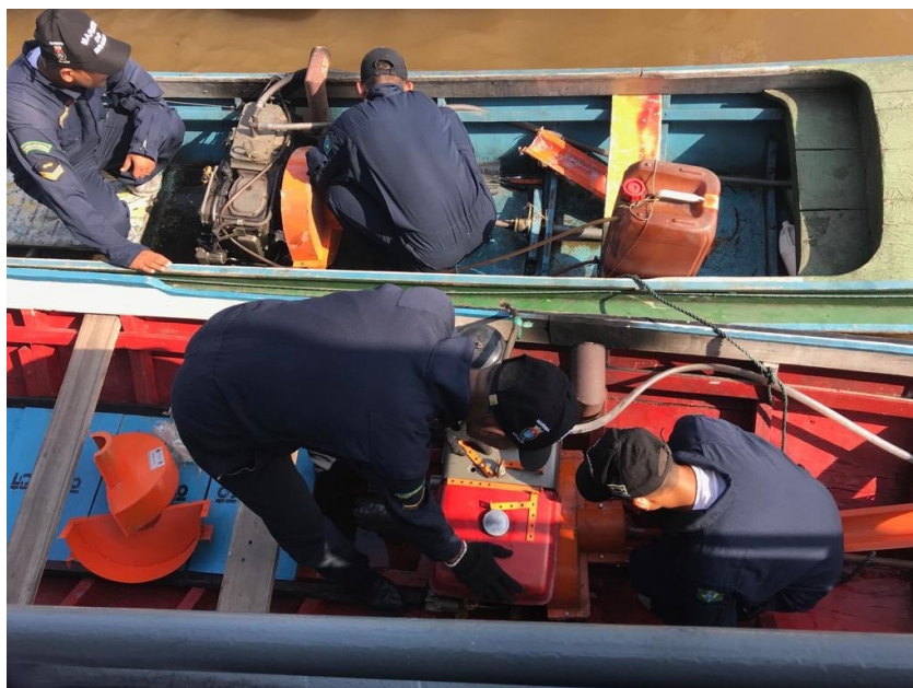
Militares instalam cobertura do eixo de motor em embarcações. O item é obrigatório
