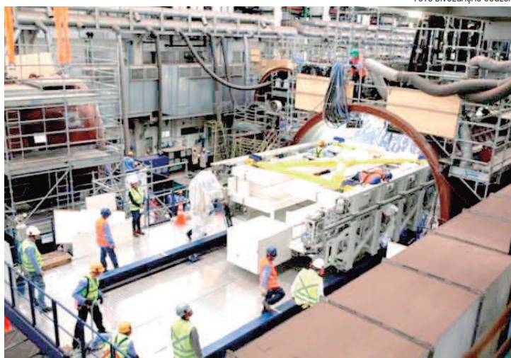
EMBARQUE DO Módulo de Manuseio e Armazenamento de Torpedos do Submarino Riachuelo, do Prosub
