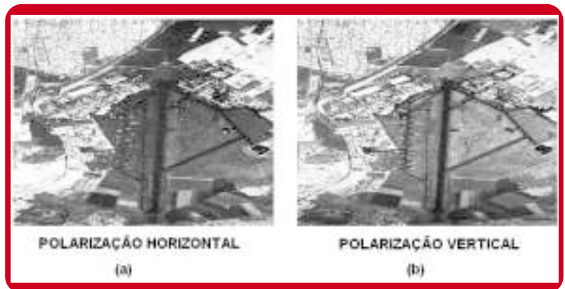
Imagens geradas pelo radar SAR-580/DLR a partir da variação da polarização do sinal transmitido
