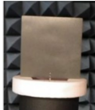
Fig. 1. Placa quadrada plana de 10cm empregada como substrato metálico a ser revestido por MARE.
