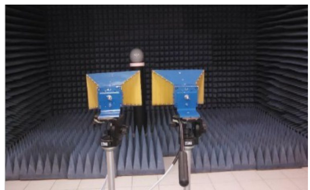
Fig. 2. Medição da refletividade do refletor de Luneberg.
