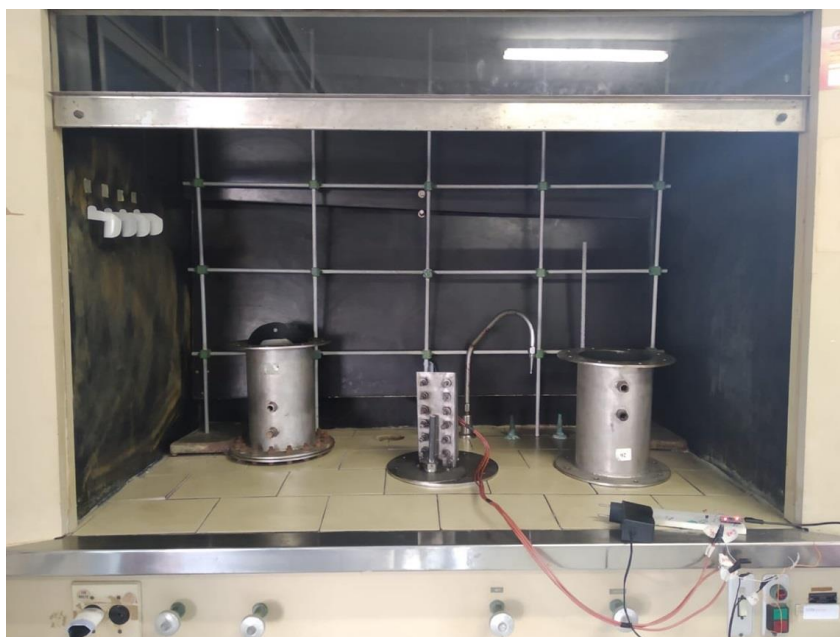
Figura 2: Strand burner em capela no Laboratório de Síntese
