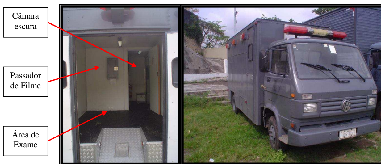
Figura 3: Caminhão Radiológico do Centro de Medicina Operativa da Marinha do Brasil Fonte: Brasil (2008c, p. 24).
