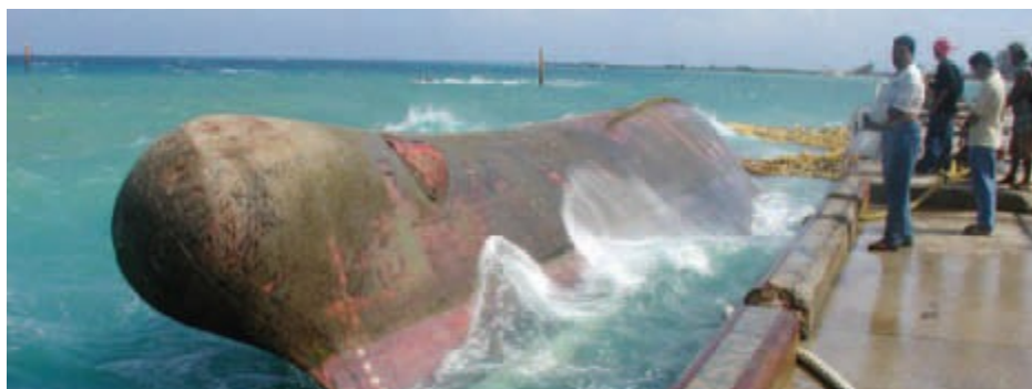
Figura 2: Barco emborcado por falta de estabilidade.
