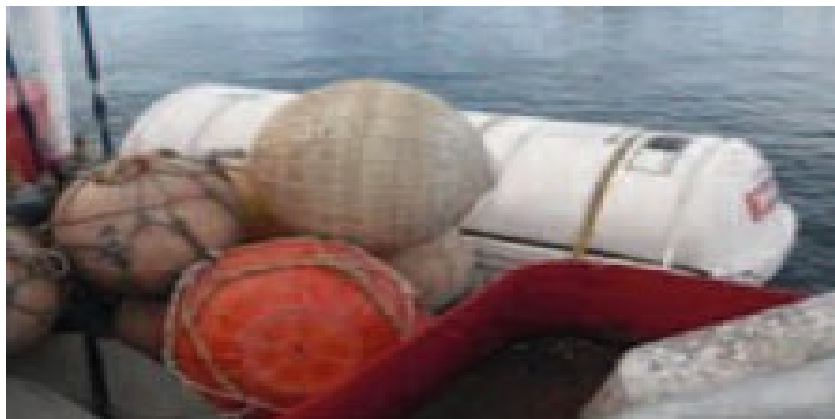
Figura 1 – Acesso obstruído a equipamento de salvatagem
