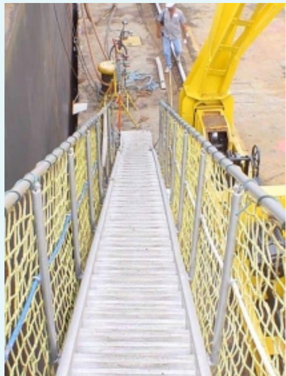
Escada de portaló
