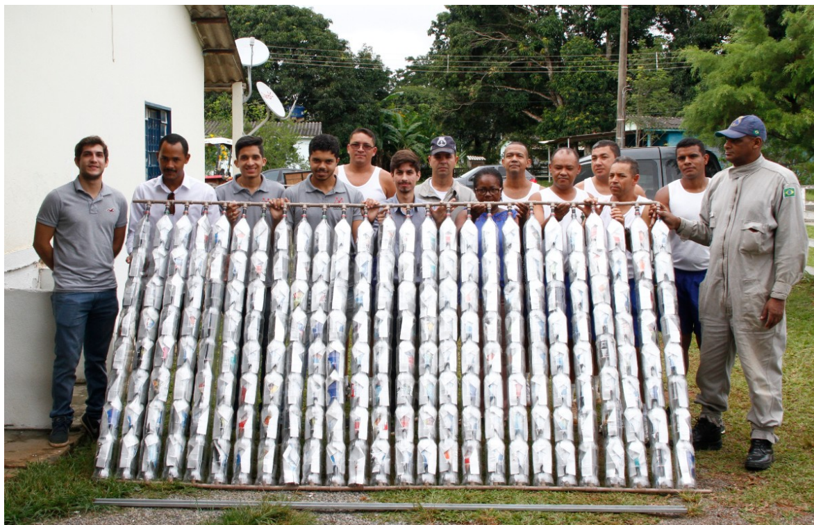
Placa de aquecimento solar de baixo custo produzida pelos moradores
