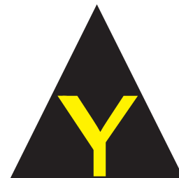
BIFURCAÇÃO DE CANAL (MARGEM ESQUERDA)
