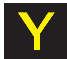
BIFURCAÇÃO DE CANAL (MARGEM DIREITA)
