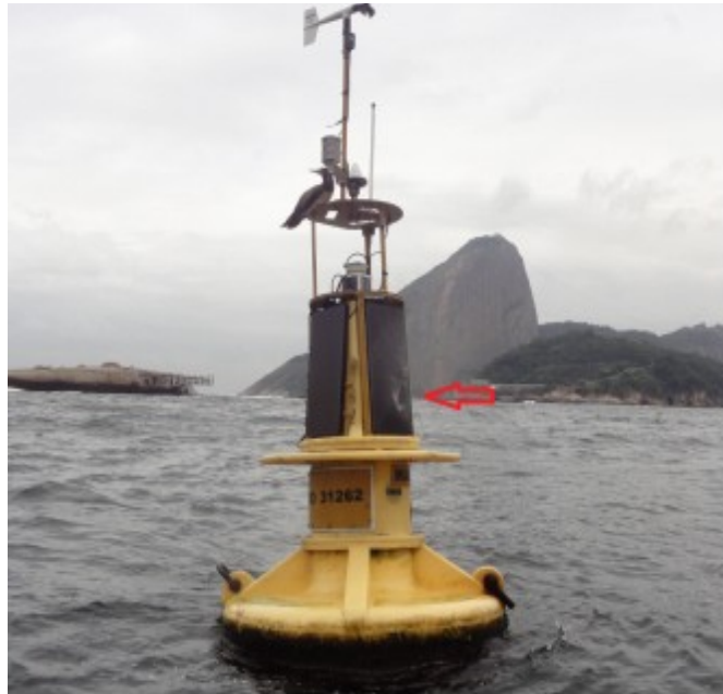
Figura 7: Por ocasião de inspeção na boia NITERÓI, foi verificada uma avaria em um dos quatro painéis solares, por um provável abalroamento na mesma.
