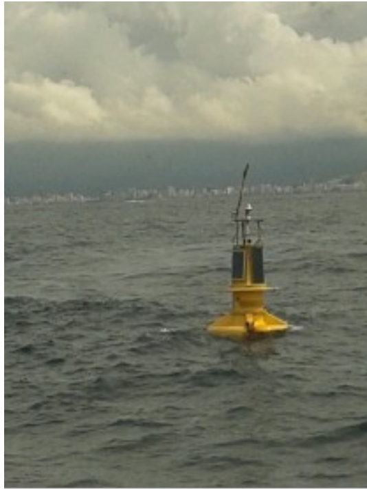
Figura 9: Foto da boia BAIA DE NITERÓI tirada da LB Pollux quando da sua passagem pela boia em março de 2017. É possível observar a ausência do anemômetro no mastro superior.
