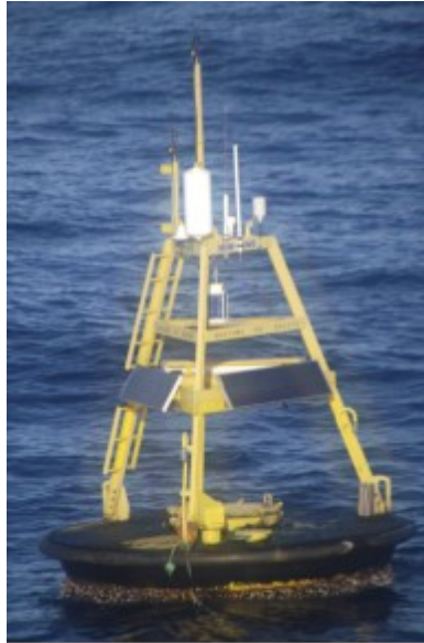
Figura 5: Foto da boia RIO GRANDE tirada pelo NHo Cruzeiro do Sul quando da sua passagem pela boia em novembro de 2013. É possível observar a ausência dos anemômetros nos mastros superiores.
