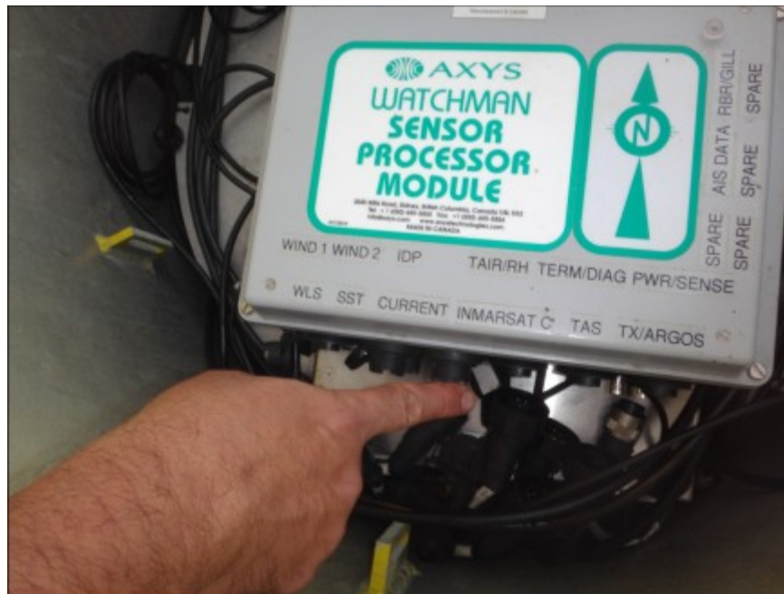
Figura 8: Foto da boia PORTO SEGURO, com detalhe para os cabos puxados da parte interior da boia.
