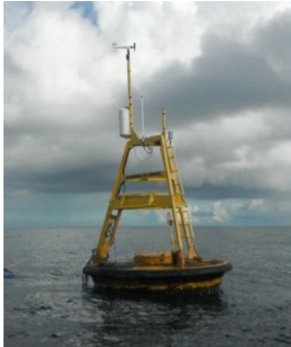
Figura 4: Foto da boia PORTO SEGURO após furto dos equipamentos em julho de 2013. É possível observar a ausência de algumas antenas, um anemômetro e painéis solares.
