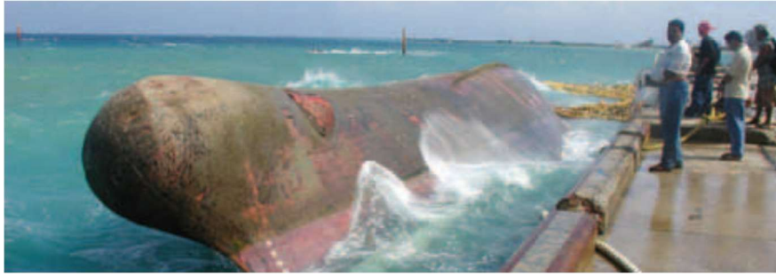
Figura 2: Barco emborcado por falta de estabilidade.
